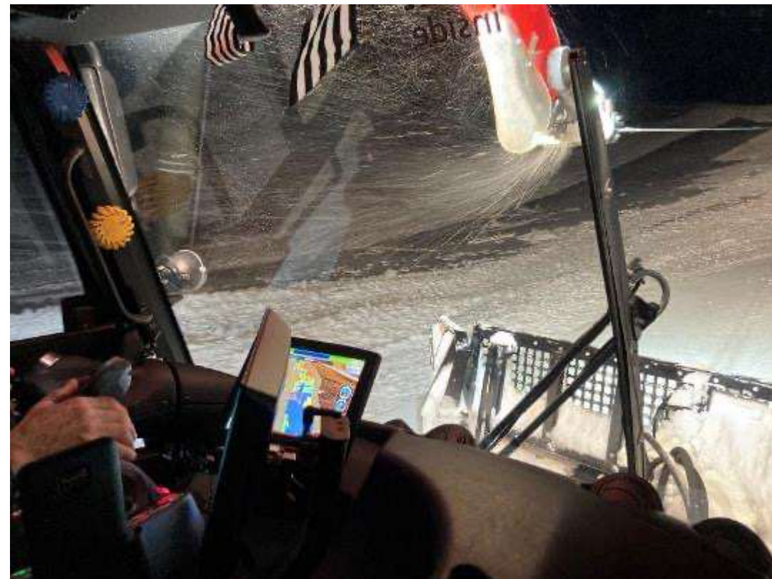
Ecran permettant de contrôler différentes fonctions de la dameuse
